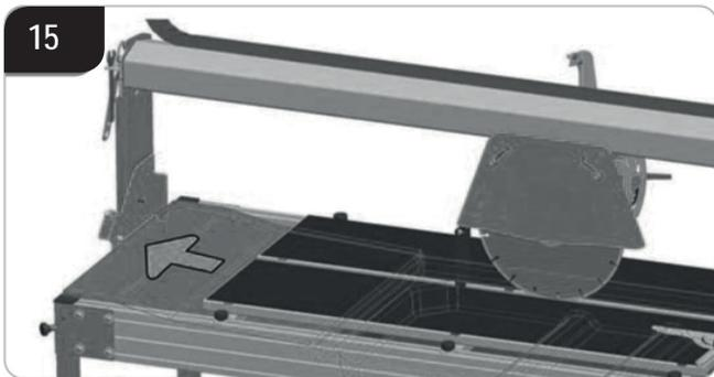
**6** Låsning af skærehoved / Lock cutting head / Snijkop blokkering
